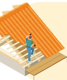
Un des premiers chantiers sera de restaurer la toiture dont les chevrons sous-dimensionnés plient sous le poids des tuiles. La charpente est, pour sa part, globalement satisfaisante hormis aux extrémités extérieures.
